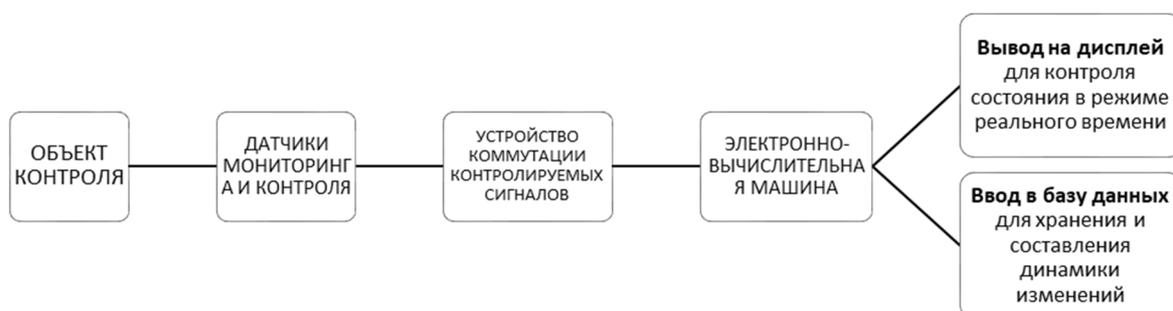
Рис. 1. Схема системы инструментального мониторинга воздействия вредных и опасных факторов
